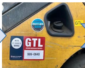
②GTL専用ステッカーを貼付
