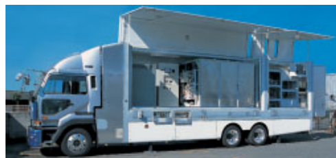
移動式水素製造設備
