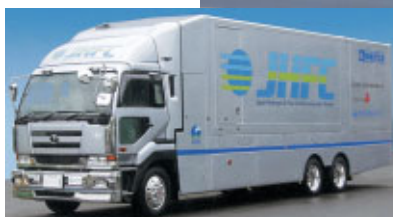
移動式水素製造設備
