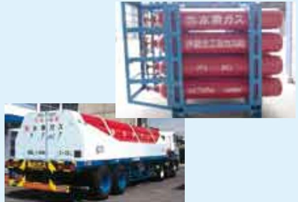
精製・圧縮された水素ガスは、その使用量、用途に応じて各種供給形態でお客様へ安定供給されています。
