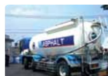
アスファルトローリー
