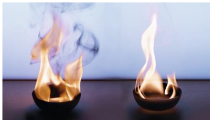
燃焼の様子（左：軽油、右：GTL 燃料）
