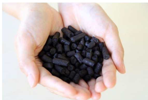
使用予定の木質バイオマス燃料（ブラックペレット）
