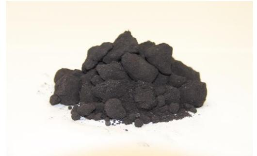
今回の試験施工では、トクヤマ発電所より発生するバイオマス燃焼灰に、トクヤマセメント工場から発生した排ガス中の CO<sub>2</sub>を固定した後、これを原料として当社の関連会社を通じて CO<sub>2</sub>固定型リサイクルビーズを製造、トクヤマ徳山製造所内の路盤工事に適用することで CCS を実現しました。試験施工完了までの一連の工程において使用した原材料とエネルギーに起因する CO<sub>2</sub>の発生量は、CO<sub>2</sub>固定型リサイクルビーズ 1トン当たり 34.2kg でした。一方で、CO<sub>2</sub>固定量は 61.0kg であることを確認し、本施工において CO<sub>2</sub>固定型リサイクルビーズ 1トン当たり 26.8kg のカーボンネガティブを達成しました。
