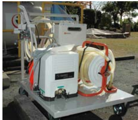
給湯器ユニット
